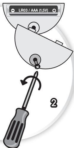
Avant de pouvoir utiliser le Pixelo commencer par installer la pile dans le produit. Cette manipulation doit être effectuée par un adulte. S'assurer que le Pixelo est bien éteint (bouton en position OFF, voir visuel 1)
