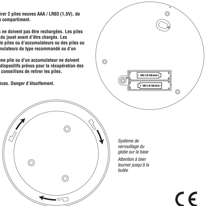
Système de verrouillage du globe sur la base
