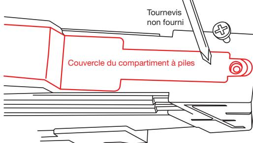
Dévisser le compartiment à piles. Insérer 3 piles neuves de type LR03/AAA (1,5 V), de préférence alcalines en respectant le sens de la polarité, dans chaque blaster Laser X Évolution. Reviser fermement le couvercle du compartiment.
