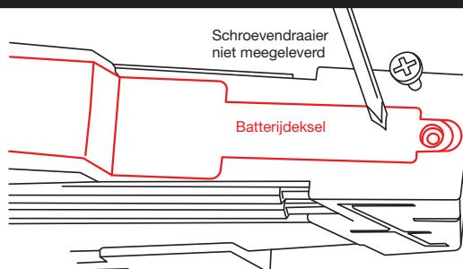
Schroef het deksel van het batterijvak. Steek 3 nieuwe batterijen van het type LR03/AAA (1,5 V) in het batterijvak van elke Blaster Laser X Evolution. Schroef het deksel van het compartiment er weer stevig op.
