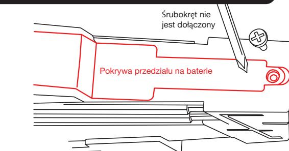
Odkrój pokrywę przedziału na baterie. Włóż 3 nowe baterie typu LR03/AAA (1,5 V), najlepiej alkaliczne, zwracając uwagę na prawidłową polaryzację, do każdego blastera Laser X Evolution. Dokładnie zakrć pokrywę przedziału na baterie.
