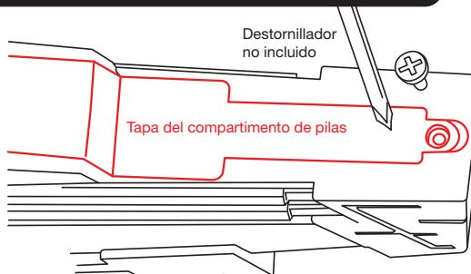
Desatornille el compartimento de pilas. Inserte 3 pilas nuevas tipo LR03/AAA (1,5 V), preferentemente alcalinas, respetando la polaridad, en cada bláster Laser X Evolution. Vuelva a atornillar firmemente la tapa del compartimento.
