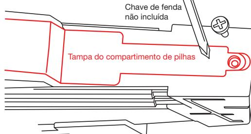
Desaperte a tampa do compartimento de pilhas. Insira 3 pilhas novas do tipo LR03/AAA (1,5 V), de preferência alcalinas, respeitando a polaridade, em cada blaster Laser X Evolution. Aperte firmemente a tampa do compartimento.
